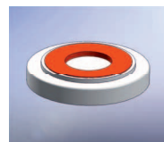
F1 – Проходной элемент с концевыми деталями и торцовым уплотнением в виде плоского резинового кольца
