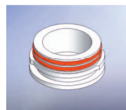
A7 (для ЭПП-101, 202 и 222) – Тупиковый элемент с плоской заглушкой и посадочным местом 56,5 мм с двухлепестковым байонетным затвором и двумя круглыми кольцевыми уплотнениями
