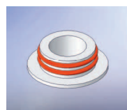
A0 (для ЭФП-101, 202 и 222) – Тупиковый элемент с плоской заглушкой и посадочным местом 44,5 мм с двумя круглыми кольцевыми уплотнениями
