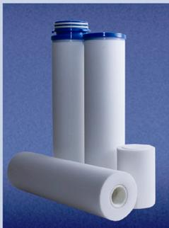
Элементы ЭКОПЛАСТ-РЕ на основе СВМПЭ с рейтингами фильтрации 1-20 мкм, хорошо регенерируются и промываются водой в направлении, обратном направлению фильтрации, обладают высокой химической стойкостью, имеют очень высокий ресурс работы. Выдерживают перепад давления до 2 МПа.
