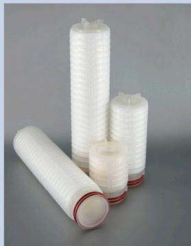
Фильтроэлементы на основе композиционного материала из стекловолокна ЭКОСТЕК обладают высоким электростатическим потенциалом и используются для тонкой осветляющей фильтрации жидкостей и удаления из них коллоидных частиц различной природы. Способность к многократным регенерациям обеспечивает высокий ресурс работы.
