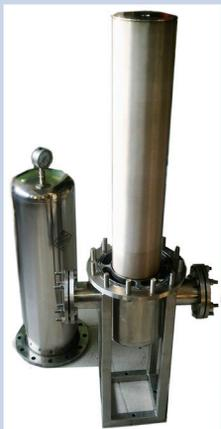
Очистка осуществляется с помощью фильтроэлементов из политетрафторэтилена (марки Ф-4) типа ЭКОПЛАСТ-ФЭП или фильтров ЭКОСТИЛ цельнометаллической конструкции с лазерной сваркой швов.
