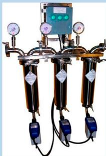
Для очистки сжатых газов и воздуха с производительностью до 500 м<sup>3</sup>/час от механических частиц, аэрозолей и капель масла и воды наша фирма производит однопатронные фильтродержатели марки ДФП-201G и многопатронные фильтродержатели с 3 или 5 посадочными местами, которые можно соединить параллельно для организации непрерывного процесса фильтрации.
