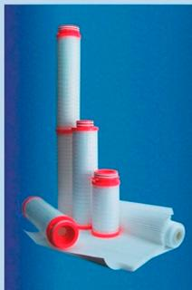
В качестве фильтрующего материала для очистки газообразных сред используются фильтроэлементы глубинного типа марки ЭКОПЛАСТ-F с рейтингом фильтрации от 0,2 до 20 мкм и гофрированного типа марки ЭКОПЛЕН-F с рейтингом фильтрации от 0,2 до 5 мкм. Рабочая температура фильтроэлементов марки ЭКОПЛАСТ-F до +160°C, а для марки ЭКОПЛЕН-F – до +135°C.
