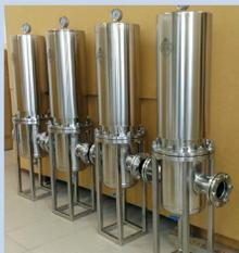
Держатели из нержавеющей стали для очистки газа ДФП с конденсатосборником, Рmax до 1.6 МПа. Подсоединение в линию – фланцевое, Ду – 25-80 мм.
