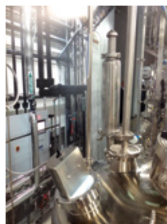
Однопатронные держатели марки ДФП-201D из стали AISI 316L для установки на емкости
