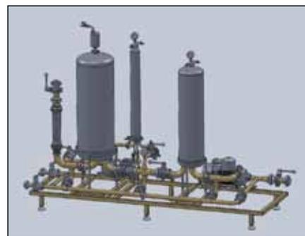
**Рис.** Установка системы «Мягкой фильтрации»™
